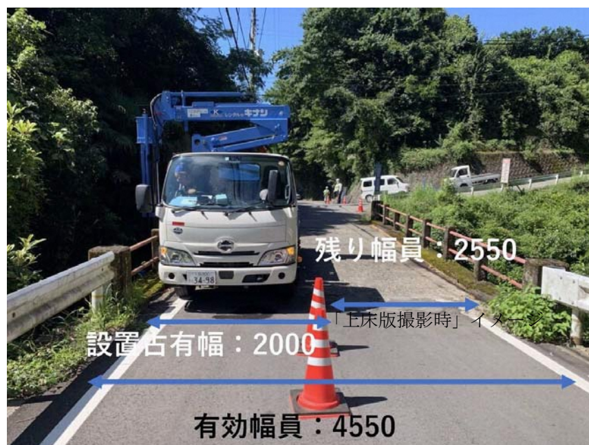
車両設置幅 1.8m の道路施設点検車 (YZ30FC SB) (NETIS 登録番号：HR-200003-A)
